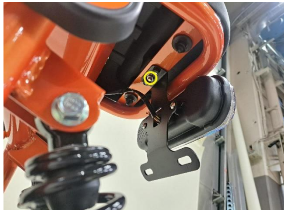
Irrota istuimen kiinnitysmutteri (kiintoavain 10 mm).
